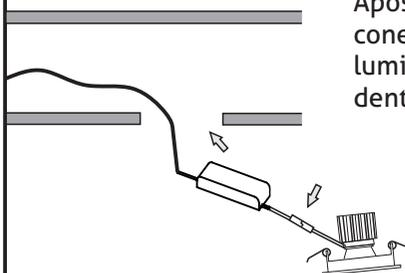
Após ligar o driver conecte os cabos da luminária e coloque-o dentro do forro.
