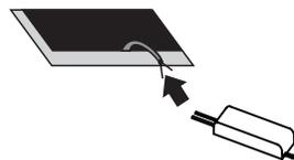
Com a rede elétrica desligada, conecte os cabos da rede no driver.
